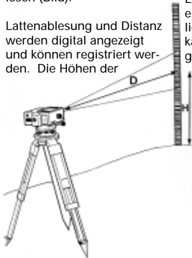
Lattenstandpunkte werden fortlaufend berechnet. Damit entfallen Ablese-, Schreib- und Rechenfehler. Für die Weiterverarbeitung der registrierten Daten werden von Leica Geosystems Softwarepakete angeboten.
